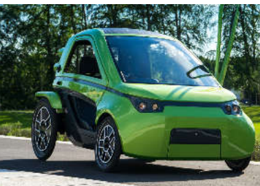
Onyx MiO mit Wechselakku und naturfaserverstärkten Materialien, Quelle: ONYX composites GmbH
